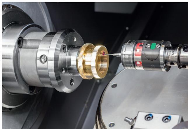
2 Der Werkstück-Messtaster TC52 wird in 5-Achs-Bearbeitungszentren und Drehmaschinen eingesetzt
