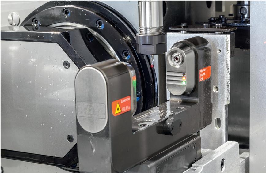
1 Selbst kleinste Werkzeuge mit einem Durchmesser von 15 hundertstel Millimeter vermisst das Lasermesssystem LC50-Digilog zuverlässig © Blum-Novotest
